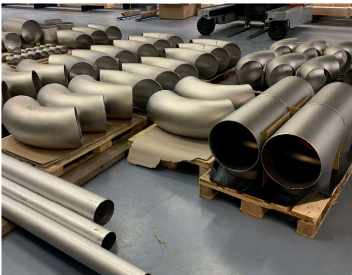
Eine typische, fast versandfertige Lieferung aus Alloy 400 Fittings, für eine petrochemische Anlage.
