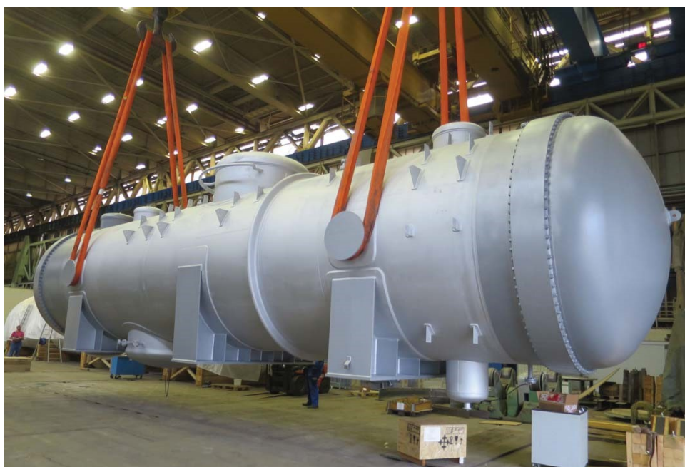
Der 135 Tonnenschwere Edelstahl-Wärmetauscher.
