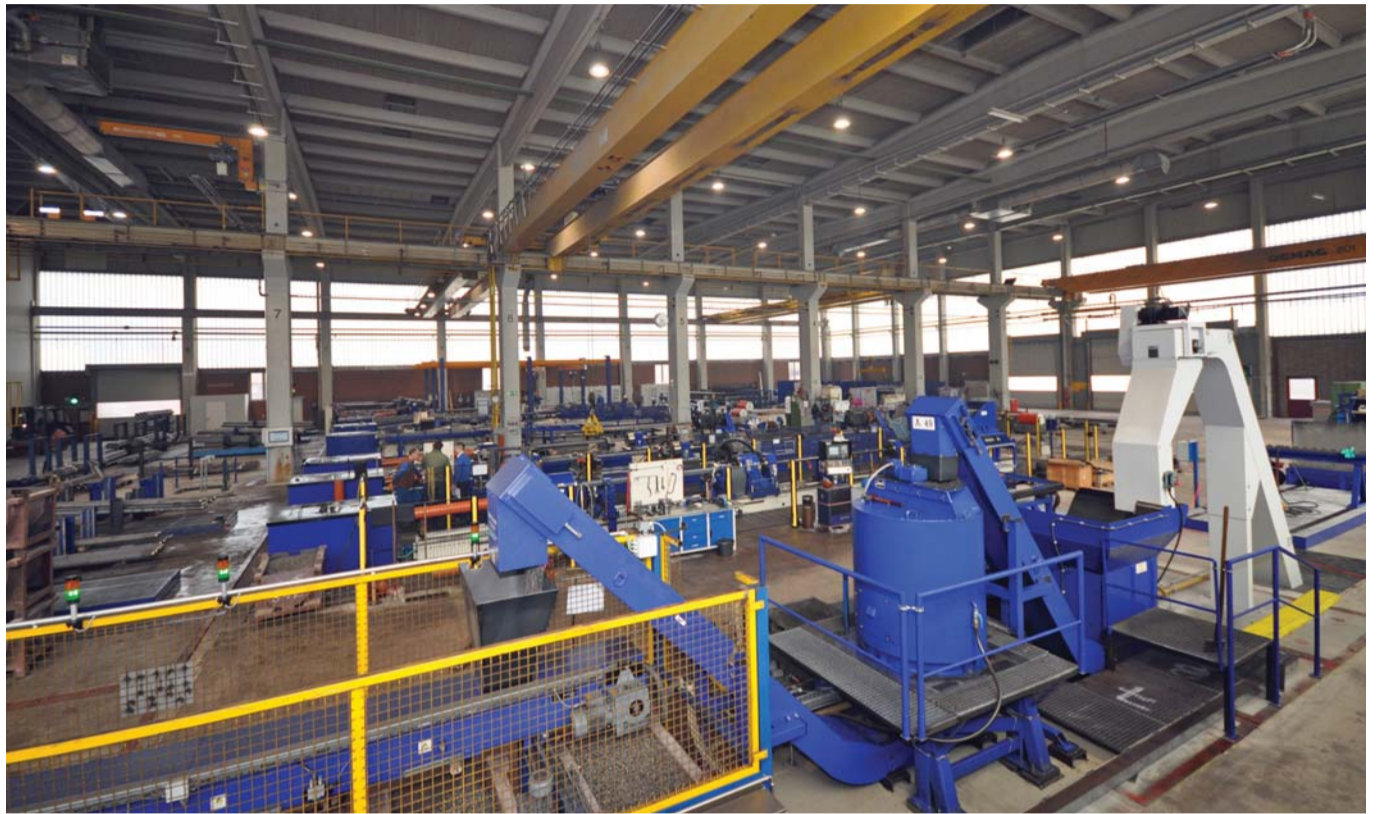
Sortenrein werden die Späne aus dem Bereich Tieflochbohren sortiert und getrocknet und anschließend wieder dem Recyclingkreislauf zugeführt.
