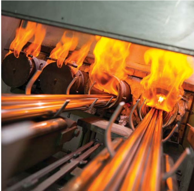
Hier geht's heiß her: Die Rohre werden durch die Glühanlage gefahren.
