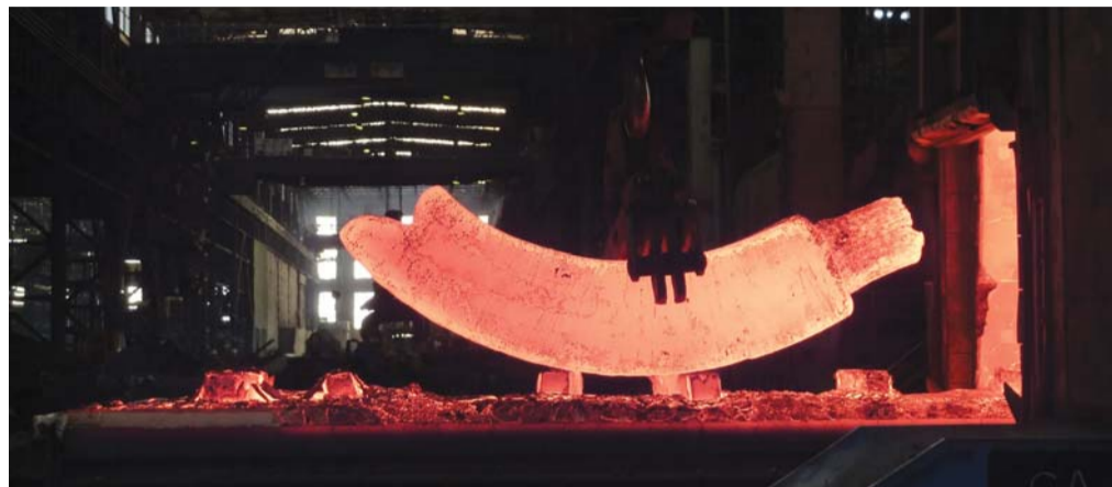
Heiße Sache: Dieser Bogen wurde bei Temperaturen von rund 1.200 °C geschmiedet. Fotos: Rolf Kind GmbH
