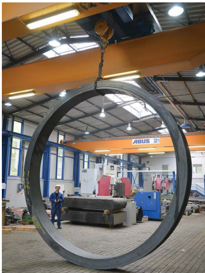
Perfektes Handwerk: Dieser Ring aus hitzebeständigem Edelstahl hat einen Außendurchmesser von mehr als 4,20 Metern und ein Rohgewicht von über 8,5 Tonnen.
