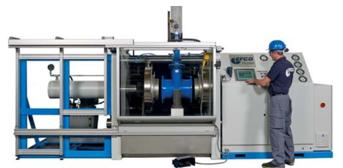
Ein automatischer Armaturenprüfstand zur Prüfung von Absperrklappen und Schiebern. Beim Schließen wird das Drehmoment gemessen. Foto: EFCO Maschinenbau GmbH
